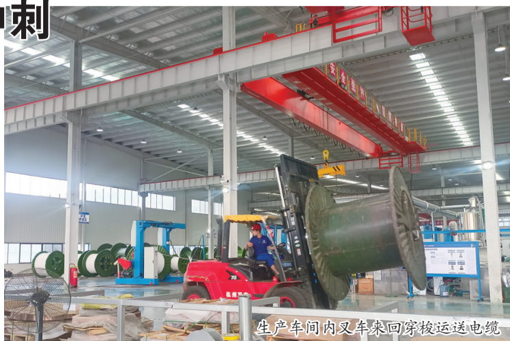
生产车间内叉车回笼搬运电缆
