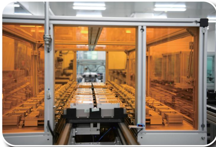
对单相电能表进行耐压试验
