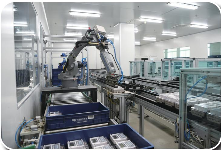
机器人自动抓取待检定电能表
