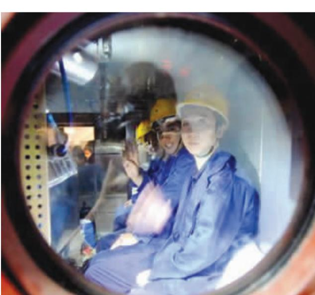
近日，一种可以在矿难发生时为井下矿工提供避难空间的“矿用救生舱”系统，在山西潞安集团模拟巷道内完成了4人、96小时的安全验证试验。
